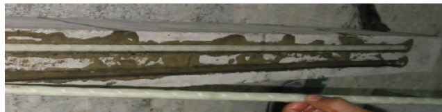
شکل ۳- نحوه قرار گیری کامپوزیت در طول تیر
