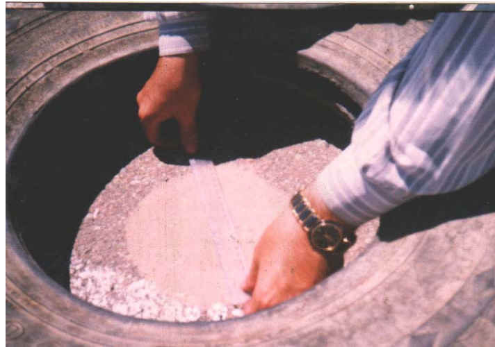
شکل ۵ - یک نمونه حفاظ باد و نحوه اندازه گیری قطر دایره در آزمایش پخش ماسه
