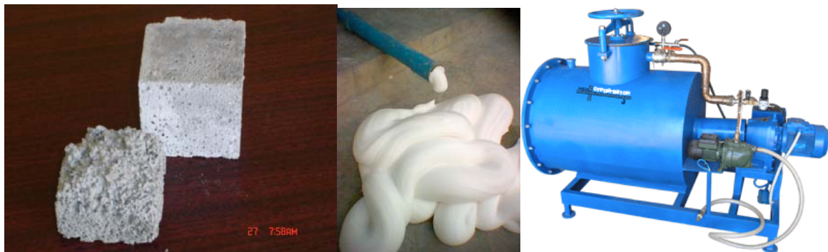
شکل ۱- نمونه بتن فومی با کف پروتئینی
