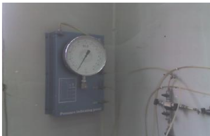
شکل 4 - تابلوی اندازه گیری فشار هم آورد و فشار تزریقی با کنترل مستمر
