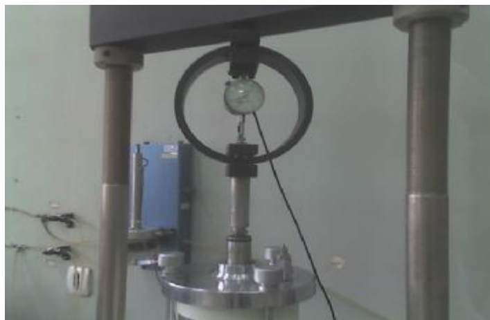
شکل 2 - حسگر رایانه ای نیروی محوری (کنترل کننده فشار هم جانبی)
