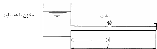
شکل ۱- لوله دارای یک نشت
