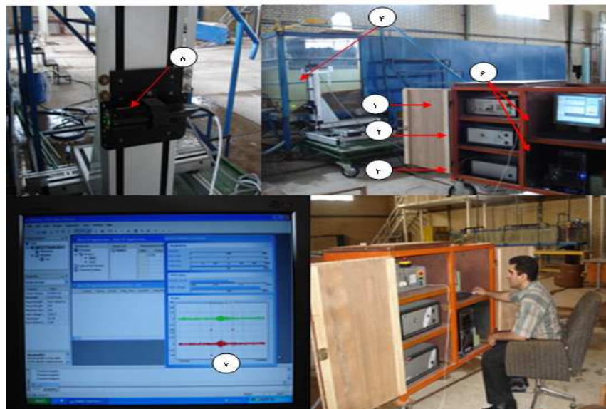
شکل ۴- دستگاه لیزر داپلر برای اندازه گیری سرعت : ۱- واحد کنترل کننده برای جابه جایی سیستم اندازه گیری (Travers System Control)، ۲- واحد تولید اشعه لیزر (Flow Lite 2D)، ۳- واحد (BSA-F60)، ۴- سیستم جا به جا کننده مکانیکی پروب اشعه لیزر، ۵- پروب تابنده اشعه لیزر ( اشعه قرمز و سبز)، ۶- واحد کامپیوتر، ۷- نمایش فرکانس اشعه قرمز و سبز دریافت شده بر روی صفحه نمایش کامپیوتر
