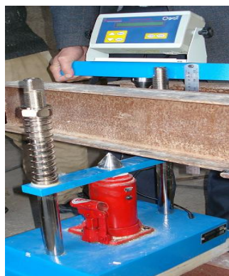
شکل ۲- دستگاه جک هیدرولیکی مورد استفاده برای اعمال نیرو
