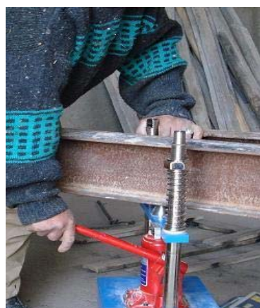
شکل ۳-چگونگی اعمال بار به نمونه‌ها
