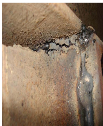
شکل ۴-جوش ترک خورده بعد از اعمال بار
