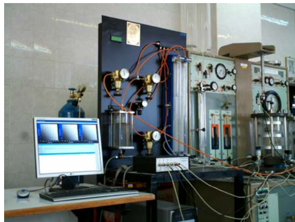
تصویر ۲- شمای کلی دستگاه سه محوری غیر اشباع
