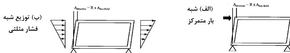
شکل ۵ - مدل‌های ساده شده قابی، [۱]. (الف) شبه بار متمرکز برای تونل‌های عمیق، (ب) شبه فشار مثلثی برای تونل‌های کم عمق
