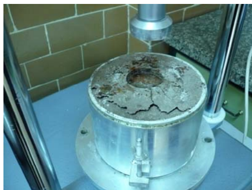
شکل ۹- نمونه تثبیت شده با ۶ درصد آهک پس از آزمایش CBR
