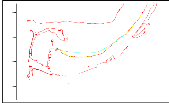
شکل ۱۰- نمایش تغییر شکل خط ساحلی در دراز مدت و حالت تعادل دینامیکی (خط آبی رنگ خط ساحلی را در حالت تعادل دینامیکی نشان می دهد)
