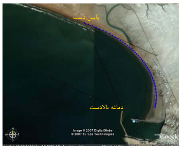
شکل ۲- نمایی از بندر بريس و منحنی تعادل استاتیکی خلیج (قرار دادن نقطه کنترل بالادست در سر موج شکن)
