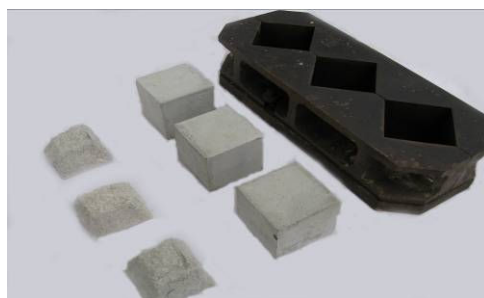
شکل ۳- تصویر قالب، نمونه‌های سالم و نمونه شکسته
