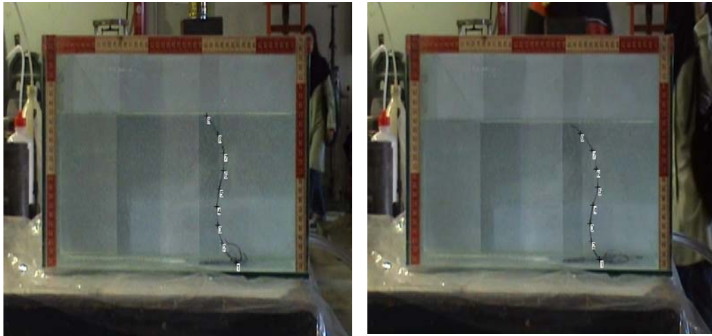
شکل ۳- کاربرد پردازش تصویر (نرم افزار Plot Digitizer) در آزمایش خروج آب از مخزن
