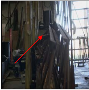
شکل شماره ۲۰: پیشش بدلیل عدم رعایت کردن نسبت عرض به ارتفاع
