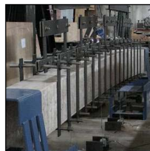
شکل شماره ۱۲: بارگذاری درختی تیر دابل با استفاده از ۱۶ نقطه بارگذار در طول تیر
