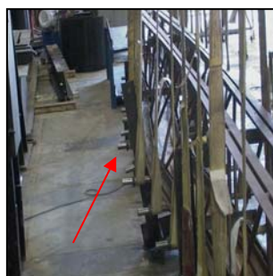
شکل شماره ۱۶: بدلیل عدم مهاربندی جانبی و بوجود آمدن کمانش در طول تیر K
