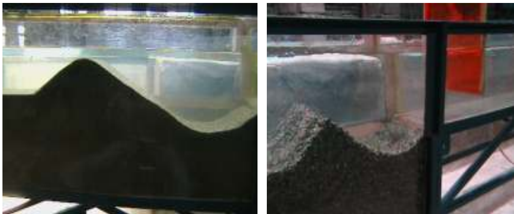
شکل ۲- نمونه‌ای از پروفیل‌های آبشستگی تشکیل شده شامل حفره و تپه پایین دست آن
