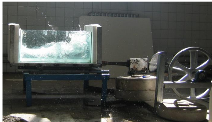
شکل (۴): نمائی از میراگر TLD سوار بر روی میز لرزه ساخته شده در اشل آزمایشگاهی
