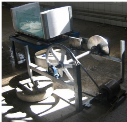
شکل (۴): نمائی از میراگر TLD سوار بر روی میز لرزه ساخته شده در اشل آزمایشگاهی
