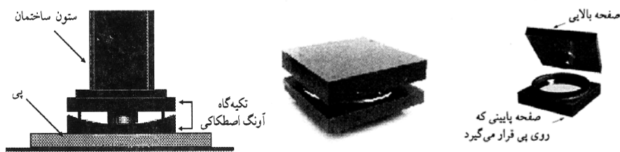
شکل ۳- شمای کلی جداگر های لرزه ای اصطکاکی و قسمت های تشکیل دهنده آونگ اصطکاکی
