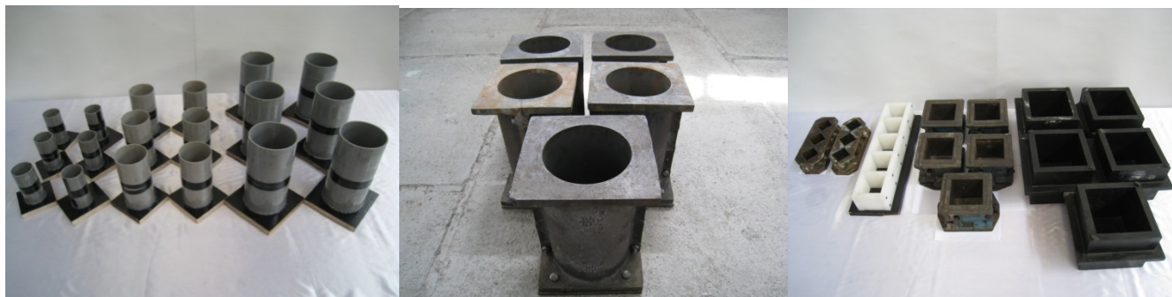
شکل ۲- قالب‌های استوانه‌ای و مکعبی به کار رفته در آزمایش
