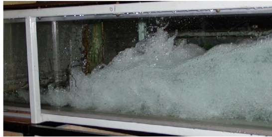
تصویر (۲) - جزئیات یک پرش هیدرولیکی
