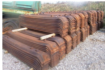
شکل (۵) - پوسیدگی و خوردگی در تراورسهای فلزی [۱]
