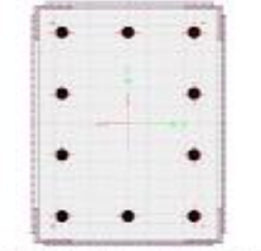
ستون ۴۰×۳۰ تقویت شده با ورق به ضخامت ۰/۵ سانتیمتر
