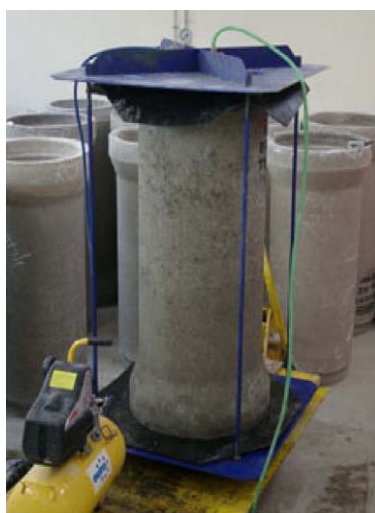
شکل ۳- آزمایش آببندی روی یک لوله
