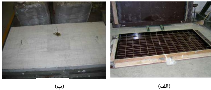
شکل ۱- نمونه پانل بتنی انعطاف‌پذیر - الف) آرماتورگذاری پانل ، ب) نمونه قبل از آزمایش
