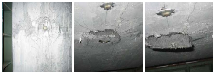
شکل ۸- وجه پشتی پانل ECC75 پس از یازدهمین تا شانزدهمین ضربه (به تدریج پس از یازدهمین ضربه در نمونه نفوذ ایجاد شده تا اینکه در هفدهمین ضربه عبور کامل صورت گرفته است)
