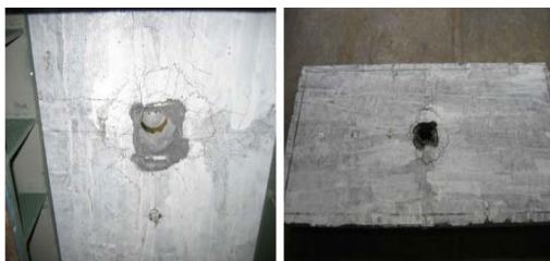
شکل ۷- وجه پشتی ECC75 پس از هفدهمین ضربه
