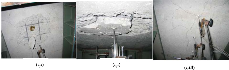
شکل ۴- آسیب وارده بر وجه پشتی پانل RC100: (الف) پس از اولین ضربه، (ب) پس از دومین ضربه (قلوه‌کن شدن زیاد)، (پ) پس از سومین ضربه (عبور کامل با ایجاد مخروط برشی بزرگ- الگوی ترک خوردگی)
